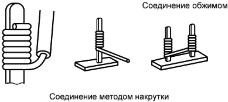
Рисунок 20 - Иллюстрация терминов "шлейфовый способ присоединения" и "сквозная проводка"
